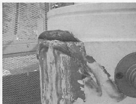
図-8 試験後縮尺キャスクの損傷状況
