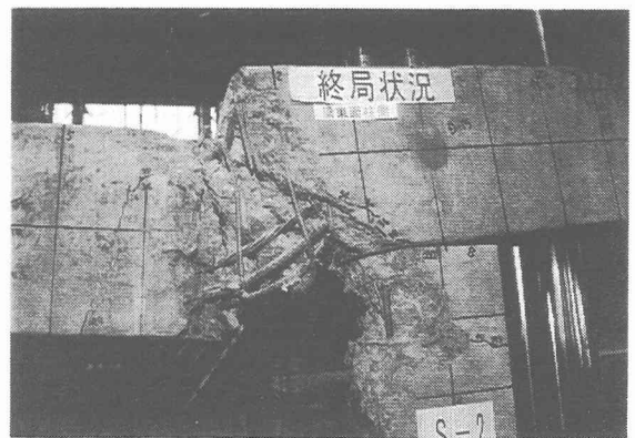
写真-2 主梁載荷点終局状況(S-2)
