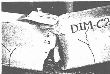
写真-2 高速荷重時の破壊状況(供試体C)
