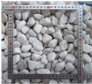
図-2 自然石で形成された礫河床の様子
