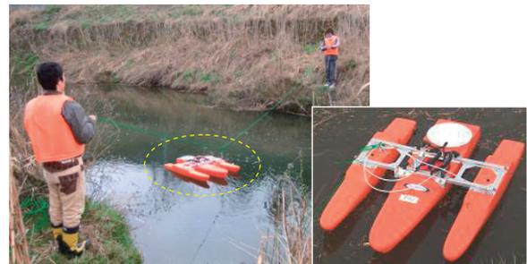
図-3 ADCP を用いた流量計測
