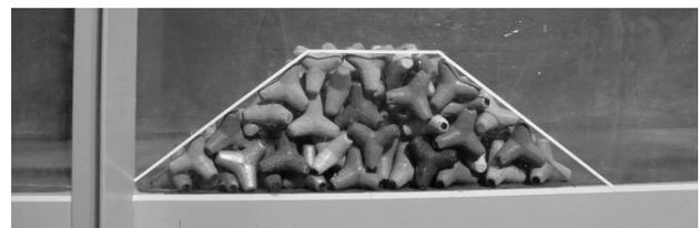
図-5 離岸堤設置状況写真
