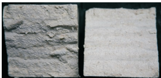
写真-3 破壊性状 ( \sigma_c=1.0\text{MPa} )
