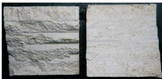
写真-2 破壊性状 ( \sigma_c=0.5\text{MPa} )
