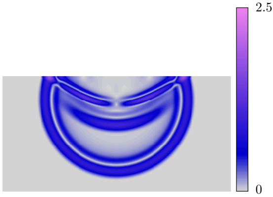
図-11 水平な自由表面のケースにおける変位速度の絶対値 \sqrt{v_1^2 + v_2^2} の分布 ( t = 0.548 )
