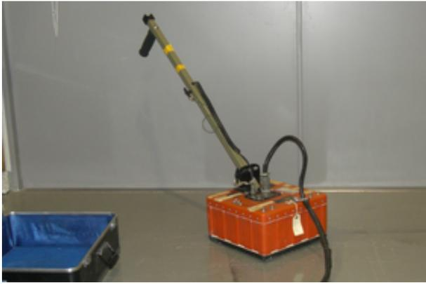
図-2 電磁波送受信アンテナ
