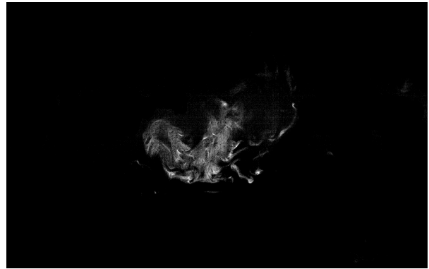
図-8(b) y/h_s=1.5 における染料の拡散
