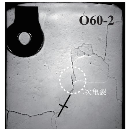
図-8 ピーク荷重到達時の供試体（シリーズO：開口不連続面）
