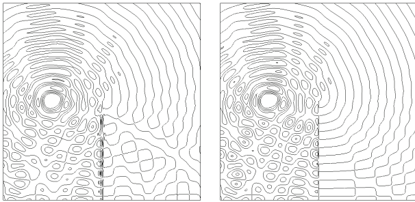
図-4 等音圧線図 (経過時間 1.0s, 等音圧線間 20Pa)
