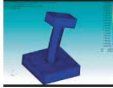
動的解析での曲げ破壊
