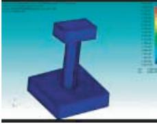
動的解析での曲げ破壊
