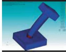
図-14 曲げ破壊の進展
