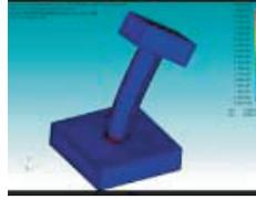
動的解析での曲げ破壊
