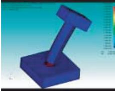
動的解析での曲げ破壊
