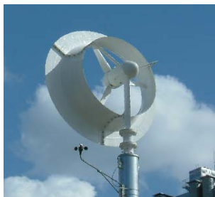
図-14 1kW 風レンズ風車 (ロータ直径 1.16m), downwind type
