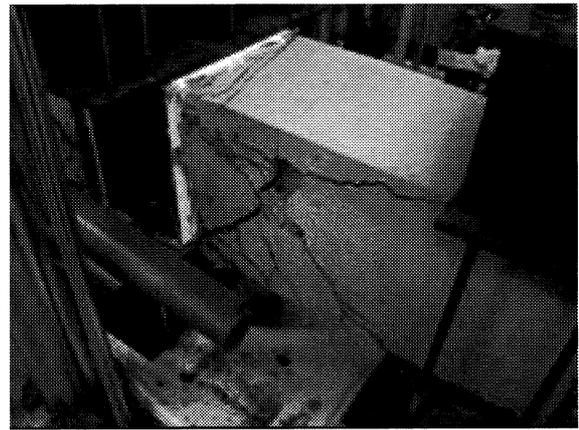
図-9 実験後の供試体 (No.1)
