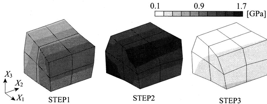
図-6 非連成マクロ解析結果: マクロ相当応力分布
