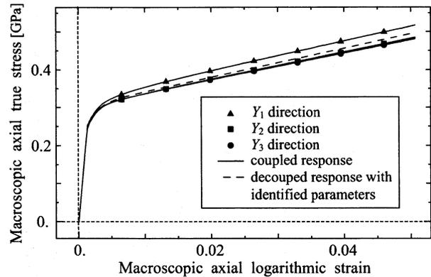
図-5 数値材料試験結果と同定したパラメータによるマクロ均質化構成モデルの応答
