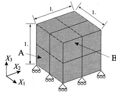
(a) マクロ有限要素モデルと注目する応力評価点
