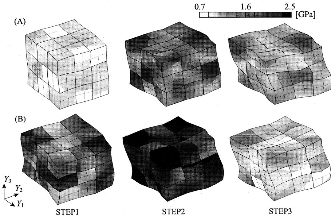
図-4 ミクロ-マクロ連成解析結果: ミクロ相当応力分布
