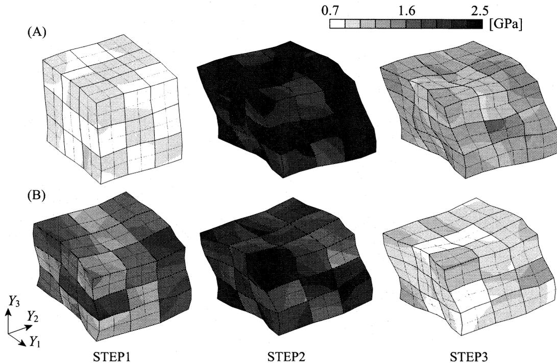
図-7 非連成ミクロ解析結果: ミクロ相当応力分布
