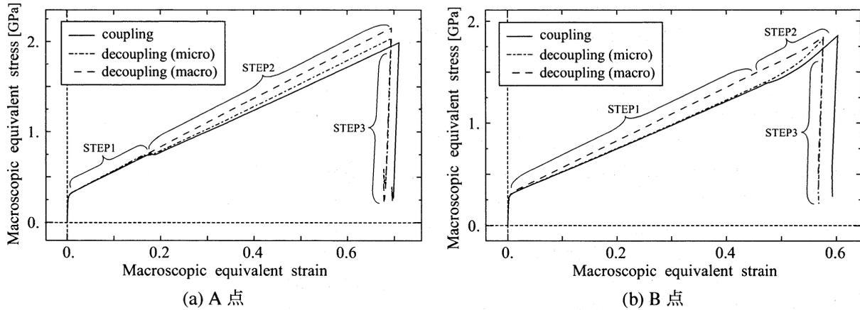
図-8 マクロ相当応力の履歴の比較
