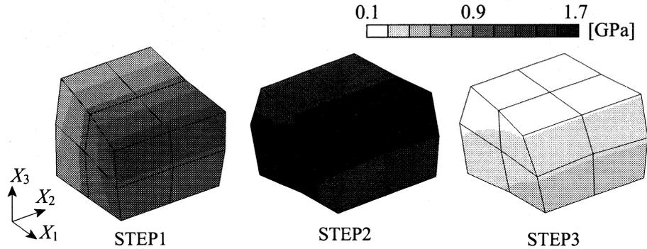
図-3 ミクロ-マクロ連成解析結果: マクロ相当応力分布
