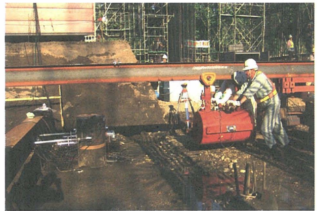
写真-1 動的水平載荷試験の状況
