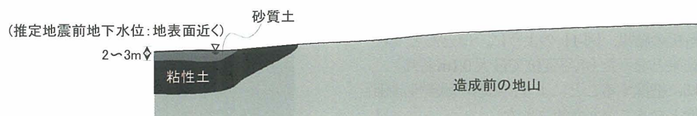
(b) 表面波探索・ボーリング調査・標準貫入試験・SWS・造成履歴等から総合的に推定される地盤構造・地下水位
