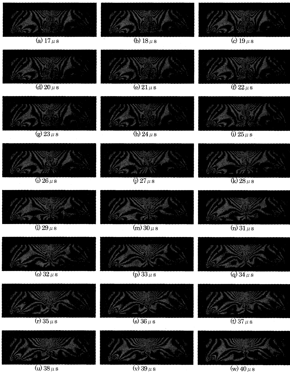
図-6 初期亀裂 5mm の供試体中での亀裂進展と進展に伴う応力分布の変化. 毎秒 100 万枚で撮影した 103 枚の画像のうち 17 \mu s 以降の 24 枚を抜き出している.
