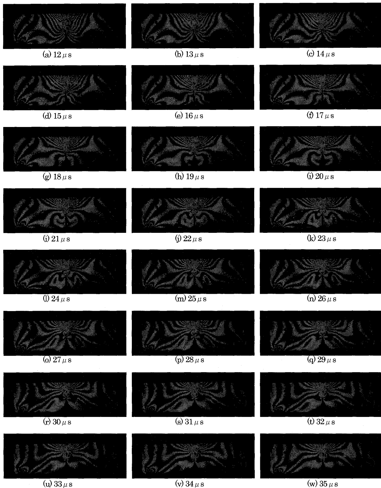
図 - 9 初期亀裂9mmの供試体中での亀裂進展と進展に伴う応力分布の変化. 毎秒100万枚で撮影した画像から, 12\mu s 以降の24枚を抜き出している.
