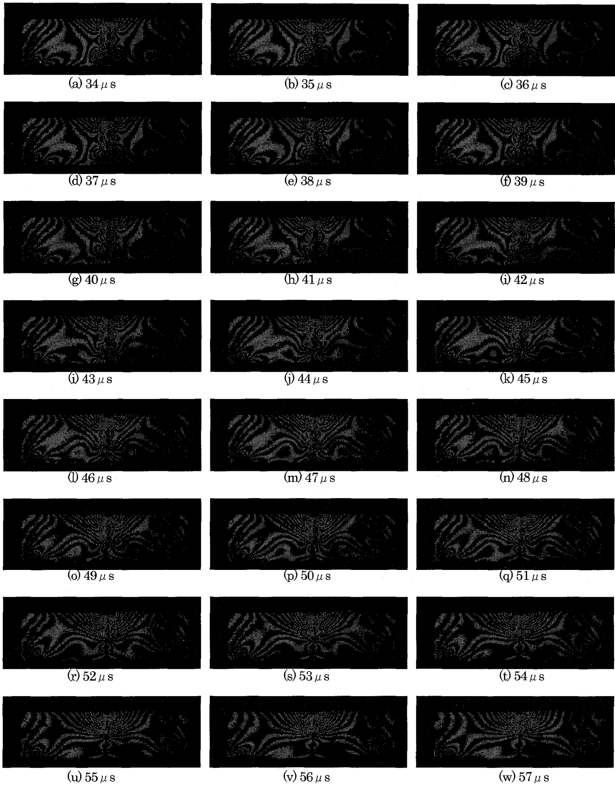
図 - 8 初期亀裂3mmの供試体中での亀裂進展と進展に伴う応力分布の変化. 毎秒100万枚で撮影した画像から, 34 \mu s以降の24枚を抜き出している.
