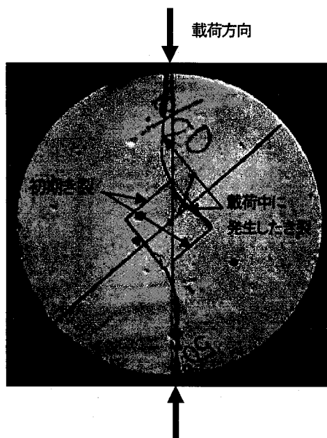
図-1 き裂進展状況 (実験後)
