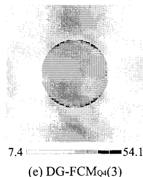
図-13 von-Mises 応力分布の比較 (MPa)
