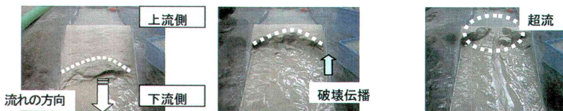
図-13 湿潤状態にある堤防の浸透破壊実験の様子： 水位差が保持条件下で堤内側（下流側）の法先から天端方向へ壊が伝播する様子。最後は越流に洗掘が生じる。
