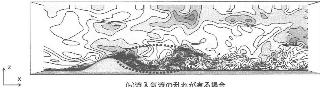
図-6 主流方向(x)の速度成分( \bar{u} )の分布, 瞬間場, スパン中央断面( y=0 ), x - z 断面, -0.4 \leq \bar{u} \leq 1.3 , h は孤立峰の高さ
