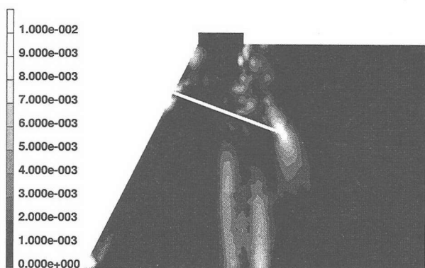
図-24 クラックひずみ (補強材打設)
