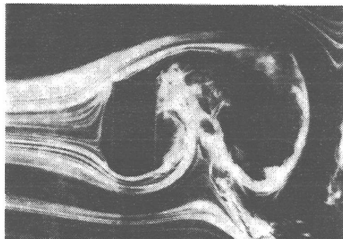
図-6 背圧低下時のフローパターン（瞬間写真） 3) : d/h = 0.5 , h = 10 cm, U = 1 m/s, Re = 6.7 \times 10^3
