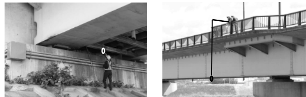
(a) 手持計測状況 (本来の計測方法) (b) 吊り下げ計測状況
