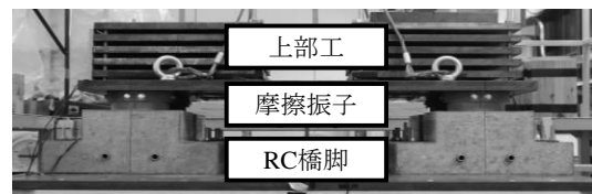
写真-1 供試体の設置状況
