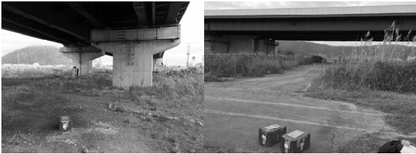
図-6 微動観測状況（左：橋の直下，右：地盤）
