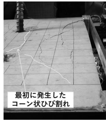
写真-8 Case-3 供試体上面のコーン状のひび割れ (載荷終了時点)
