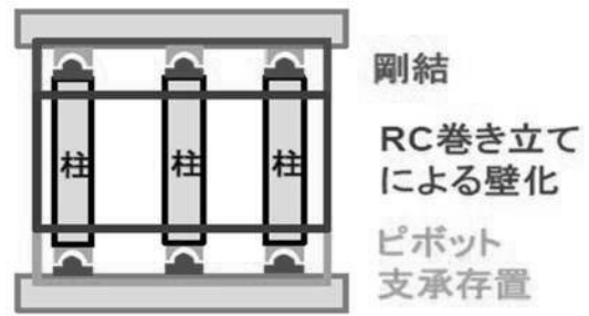
図-4 完全自立構造とする補強例
