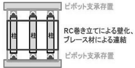
図-5 半自立構造とする補強例
