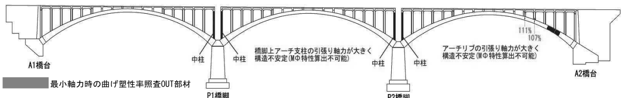
図-10 衝突を考慮した曲げ耐力照査(橋軸方向 レベル2タイプII-I-1波形)
