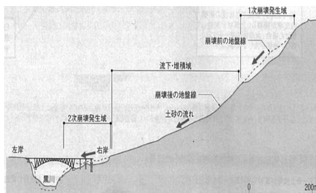
図-8 阿蘇大橋付近の二次崩壊模式図 3)
