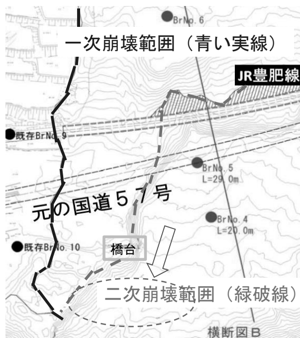
図-19 一次崩壊状況拡大図 6)
