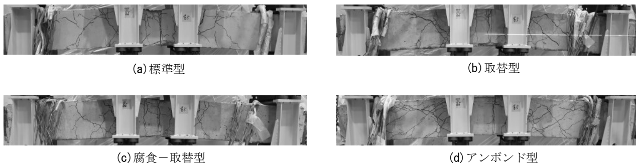
図-21 終局時の各供試体の荷重側面の様子
