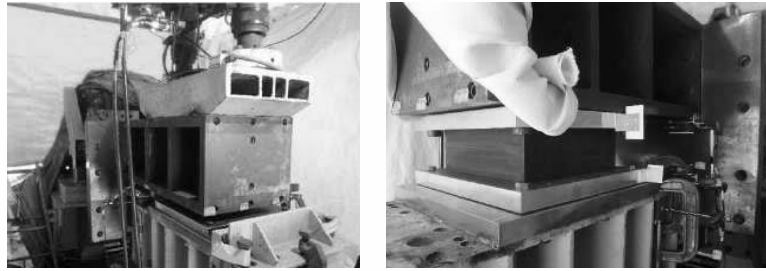
写真-1 荷重状況（左；下沓プレート荷重試験，右；支承部構造荷重試験）
