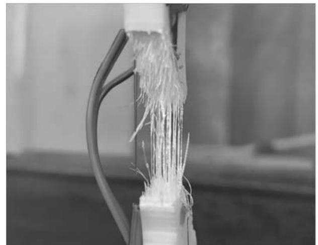
写真-10 脆性破壊の様子
