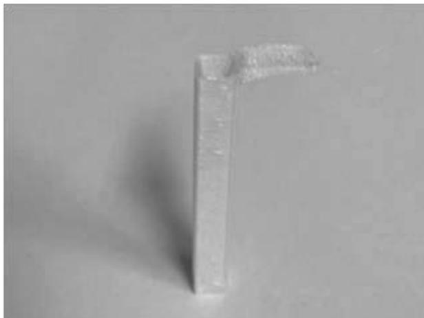
写真-6 高さ方向の積層の失敗例
