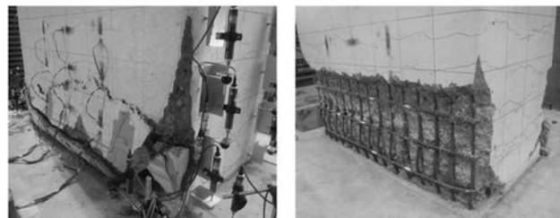
(a) No.1 (左: 8\delta_y-3 回目 右: 実験終了 かぶり除去後)
