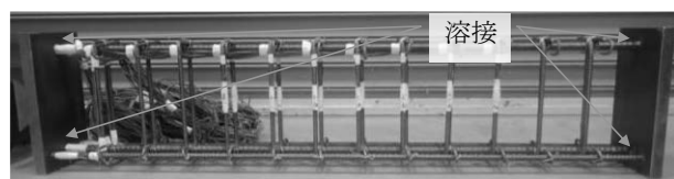
(d) 鋼板と鉄筋の溶接箇所
