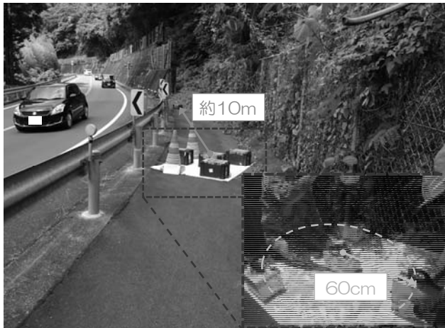
図-6 微動観測（極小アレー観測）
