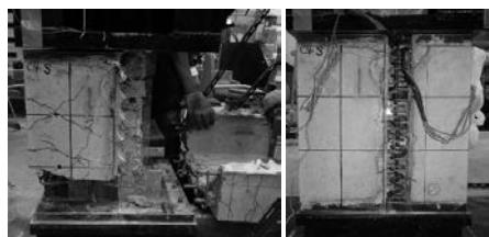
(a) 取り外し状況 (b) 新外殻部材設置
