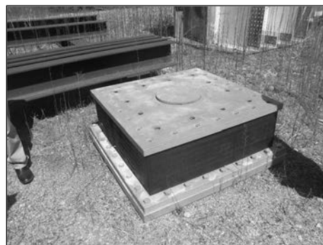
写真-2 実物ゴム支承現地保管状況
