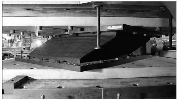
図-6 45°方向水平載荷試験状況
