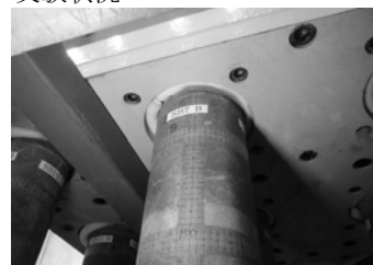
写真-2 既設杭模型とフーチング模型の結合部
