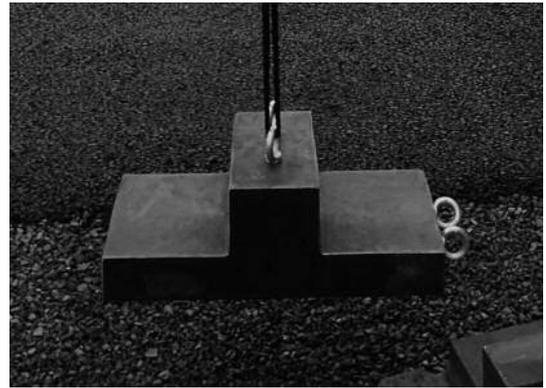
写真-4 試験片の形状
