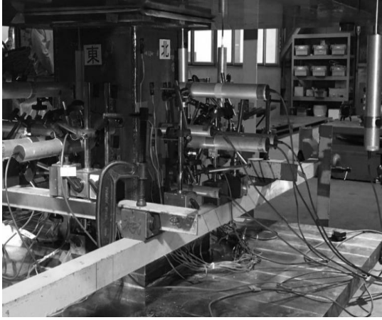
図-3 軸圧縮試験の様子
