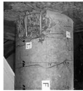
図-7 F杭(押込み側)における±8δ y 時の損傷状況比較(Case2)
