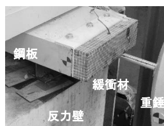
写真-3 緩衝材設置状況
