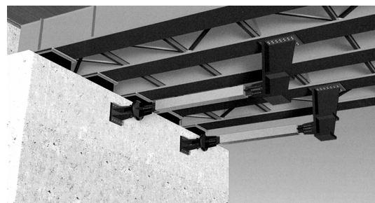
図-1 ダンパーを橋台の可動支承に併設した状態
