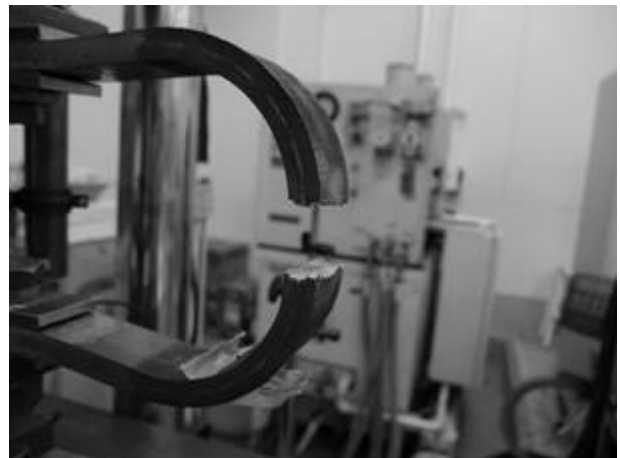
写真-2 破断箇所（R80b100t16e21tp8.3±6 \delta_y ）
