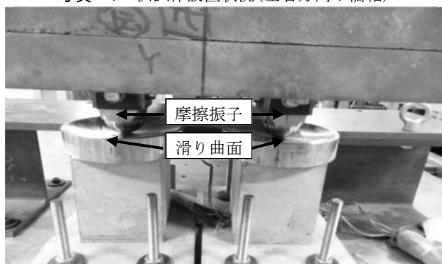
写真-2 供試体設置状況(左右方向：橋軸直角)
