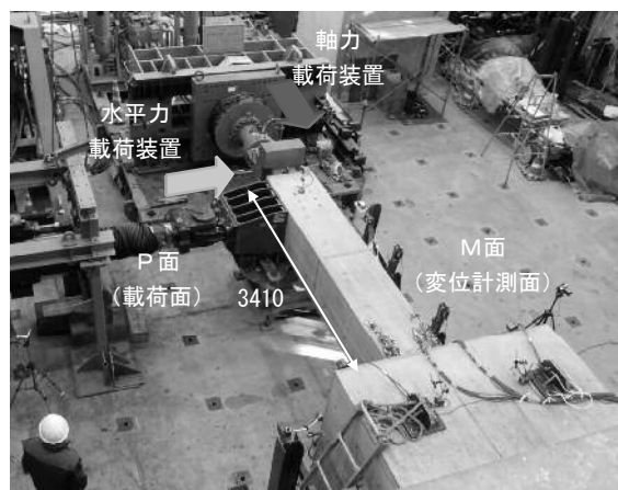
図-2 実験供試体設置状況 (単位:mm)
